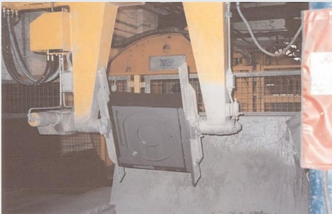
← **PERMACOL:** Hervorragende Formfestigkeit gestattet zeitiges Handling der Formen. Hohe Reaktivität ermöglicht reduzierten Säuregehalt.
